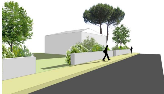
Mur bahut de 0,8 mètre, surmonté ou non d'une grille, doublé ou non de végétation pour une hauteur totale de 1,60 mètre
