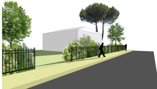
Mur bahut de 0,8 mètre, surmonté ou non d'une grille, doublé ou non de végétation pour une hauteur totale de 1,60 mètre
